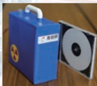
USBで駆動する超小型 ポータブルX線源
