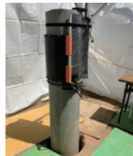
X線管理区域が設定不要の電柱用ポータブル・フレキシブルX線検査装置
