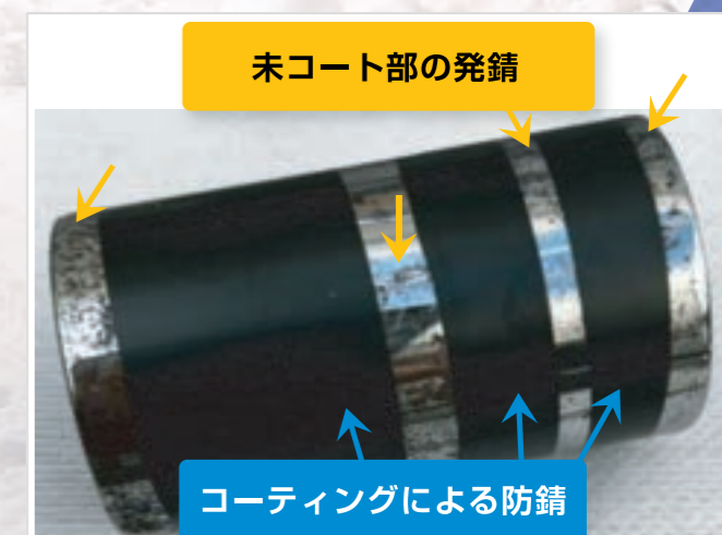
セラミックスプレーコーティングによる錆防止 (4年間)
