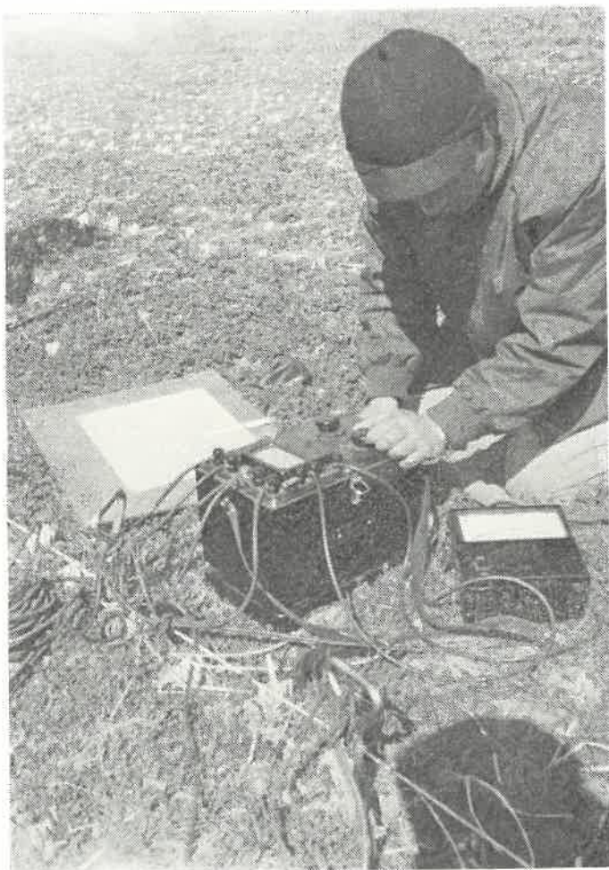
写真-21(a) 電気探査の操作
