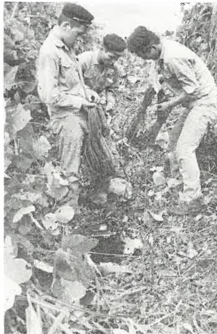
写真-21(b) 電気探査, 4 極法のため補助員 4 名いると能率的
