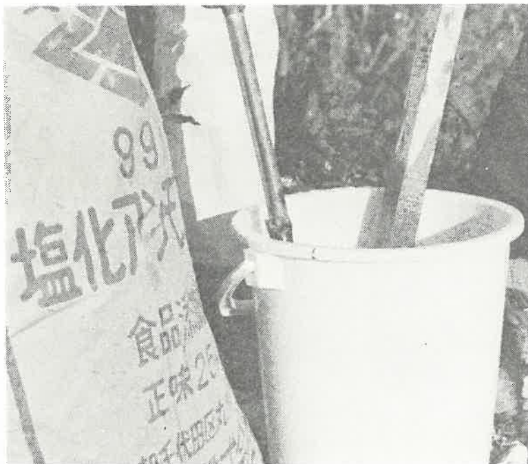
写真-33(a) 薬品投入による地下水系調査
