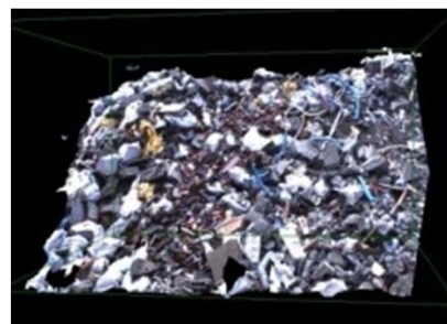
【ガレキの3次元点群データ、体積計測】
