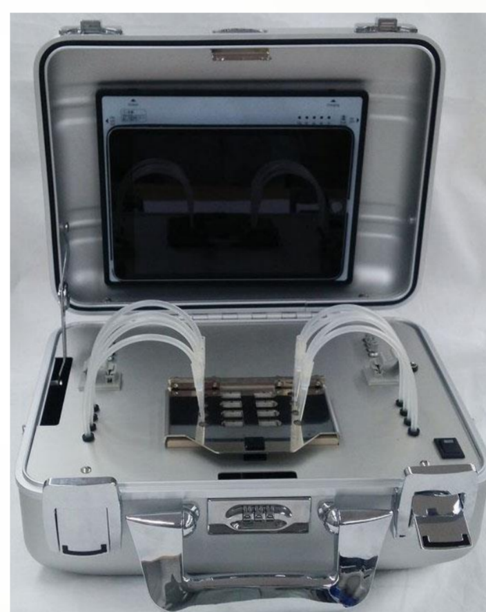
開発期の高速遺伝子検査装置「GeneSoC®」 ○ 可搬型アタッチケースタイプ ○ ハンドヘルドタイプ (日本板硝子社製)
