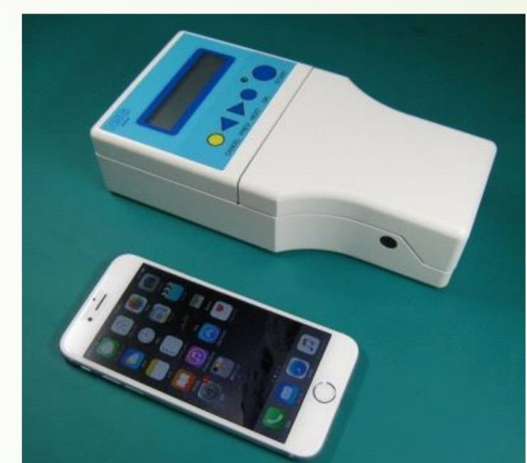
開発期の高速遺伝子検査装置「GeneSoC®」 ○ 可搬型アタッチケースタイプ ○ ハンドヘルドタイプ (日本板硝子社製)
