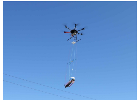
ドローン空中磁気探査システム （大熊ほか，2023に加筆修正）
