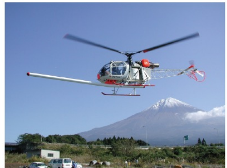
スティンガー方式空中磁気探査用ヘリコプター （大熊ほか，2016； 富士火山地域高分解能空中磁気異常図）
