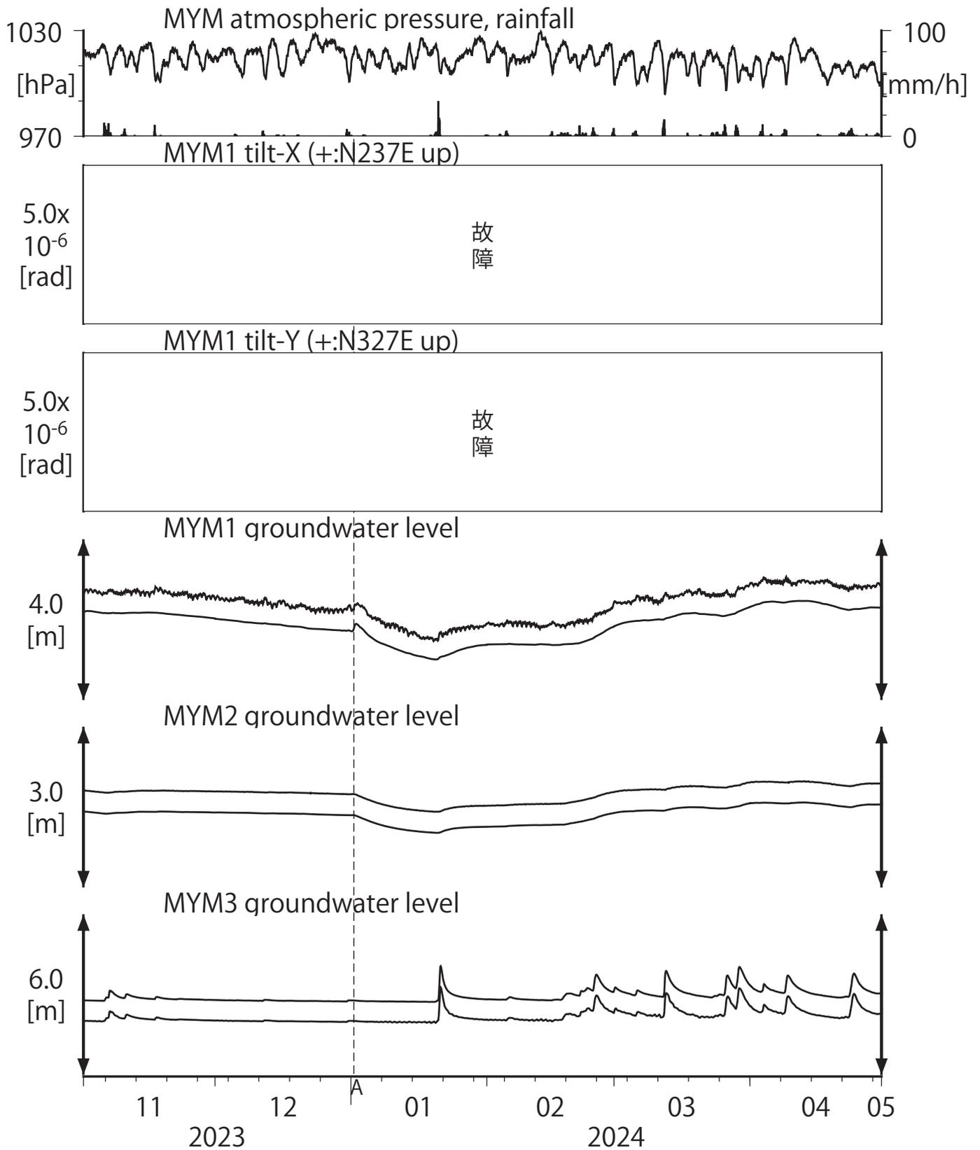
Tiltmeter depth = 589.2-590.0 [GL-m]      A:2024/01/01 能登半島地震 M7.6
