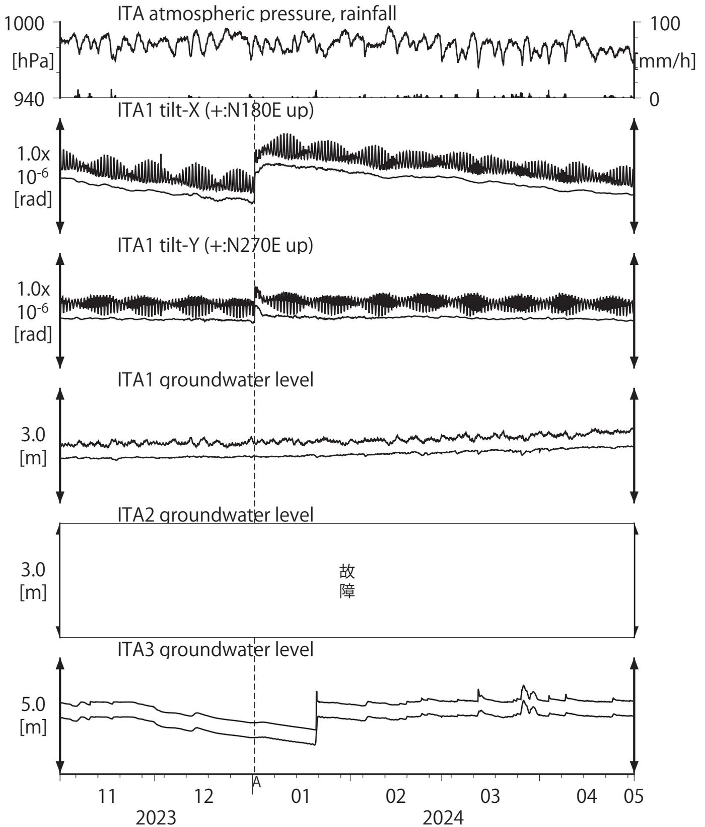
Tiltmeter depth = 596.7-597.3 [GL-m]      A:2024/01/01 能登半島地震 M7.6
