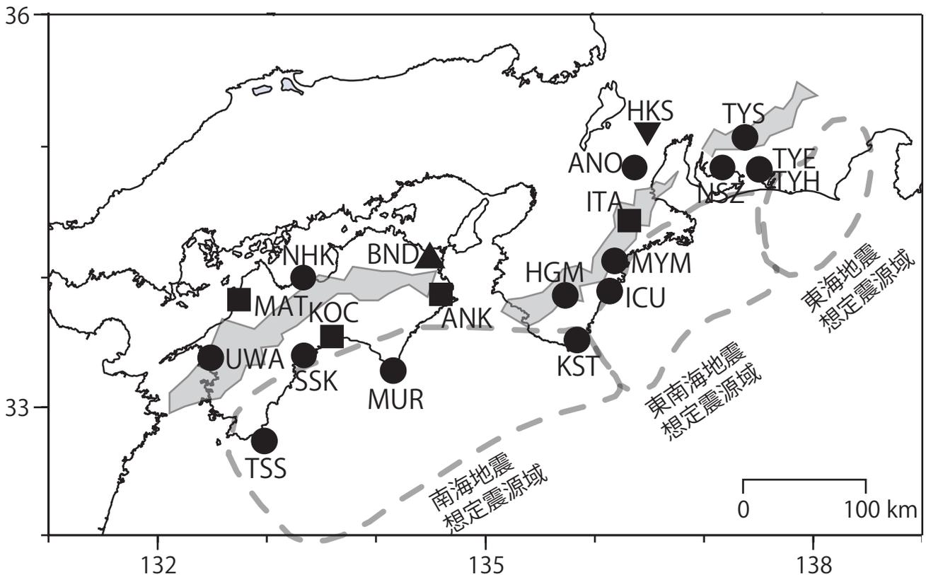
第1図: 産総研の地殻変動・地下水観測点の分布図 (●・■・▲・▼)。それぞれの観測点に設置されている機器は次のとおり。●はボアホール歪・傾斜計 (デジタル) および水位計。■は傾斜計および水位計。▲はボアホール歪計 (アナログ) および水位計。▼は水位計。灰色の領域は短期的SSEおよび深部低周波微動が定常的に発生していると考えられる地域。
