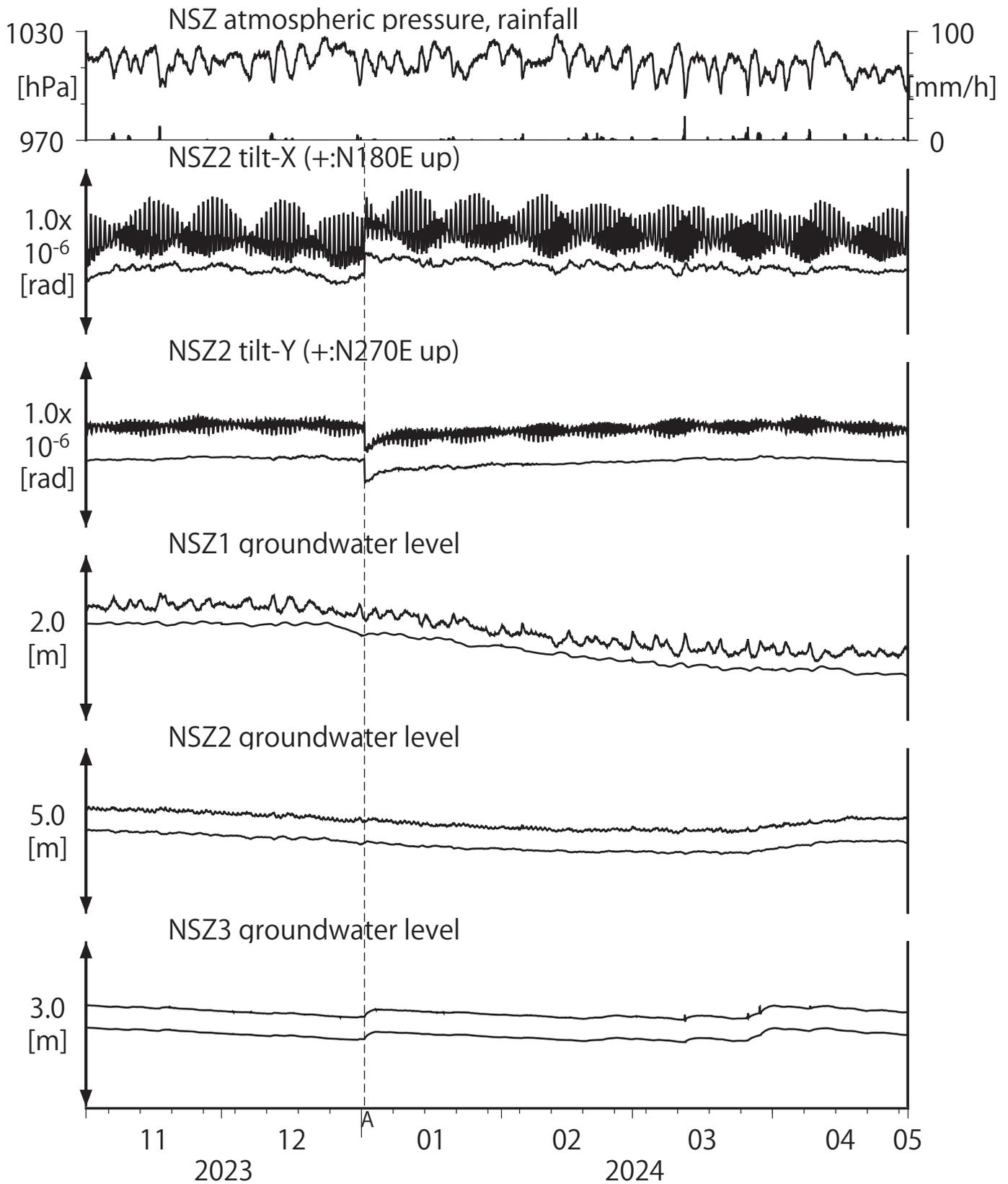
Tiltmeter depth = 194.7-195.3 [GL-m]      A:2024/01/01 能登半島地震 M7.6
