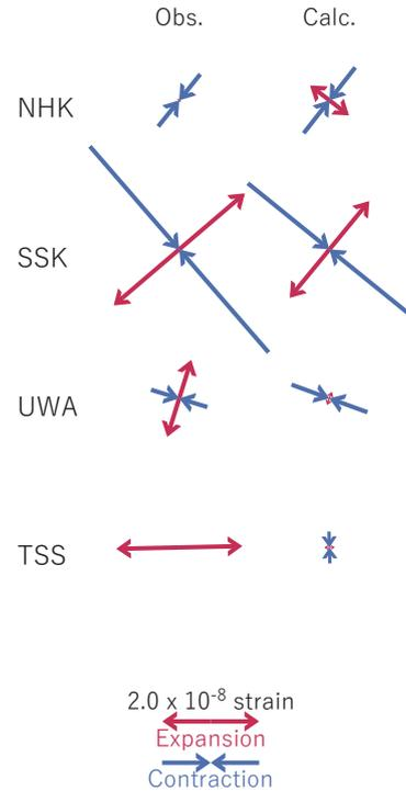
図52 2021/07/21PM-27の歪・傾斜変化 (図48,49[C]) を説明する断層モデル。
