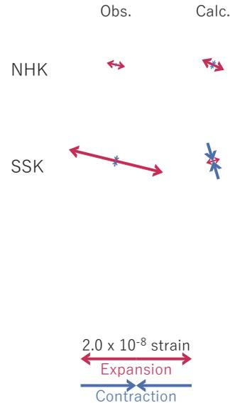
図50 2021/07/18-19AMの歪・傾斜変化 (図48,49[A]) を説明する断層モデル。
