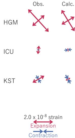
図58 2021/07/22PM-24AMの歪変化 (図56[B]) を説明する断層モデル。
