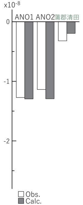
図42 2021/05/13-14AMの歪・傾斜・地下水変化 (図38-40[B]) を説明する断層モデル。
