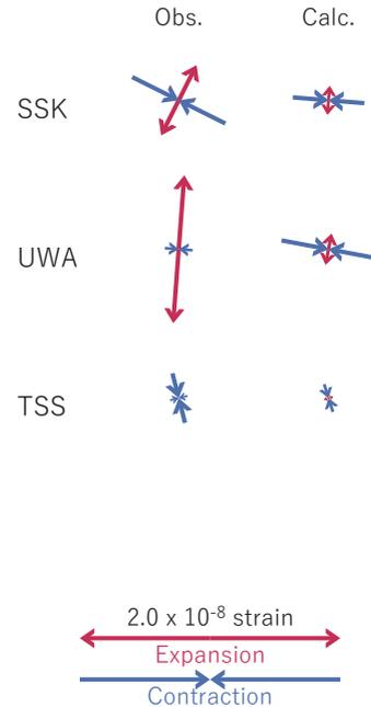
図53 2021/07/28の歪・傾斜変化 (図48,49[D]) を説明する断層モデル。
