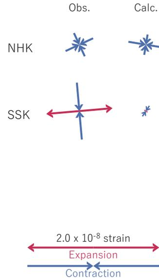
図51 2021/07/19PM-21AMの歪・傾斜変化 (図48,49[B]) を説明する断層モデル。
