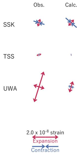
第46図 2020/02/21PM-22の変化（第38-40図[F]）を説明する断層モデル。
