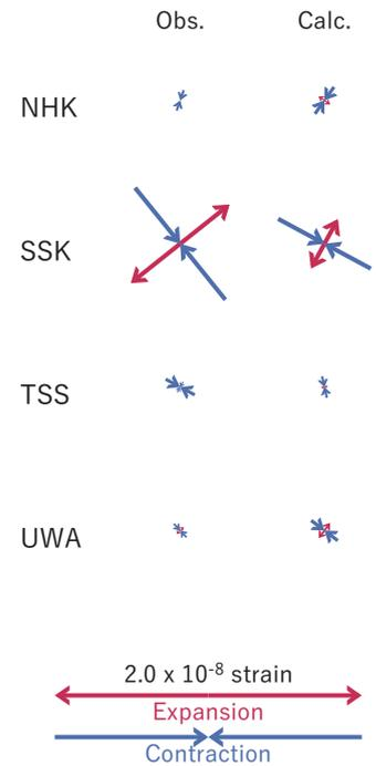
第44図 2020/02/19-20AMの変化 (第38-40図[D]) を説明する断層モデル。
