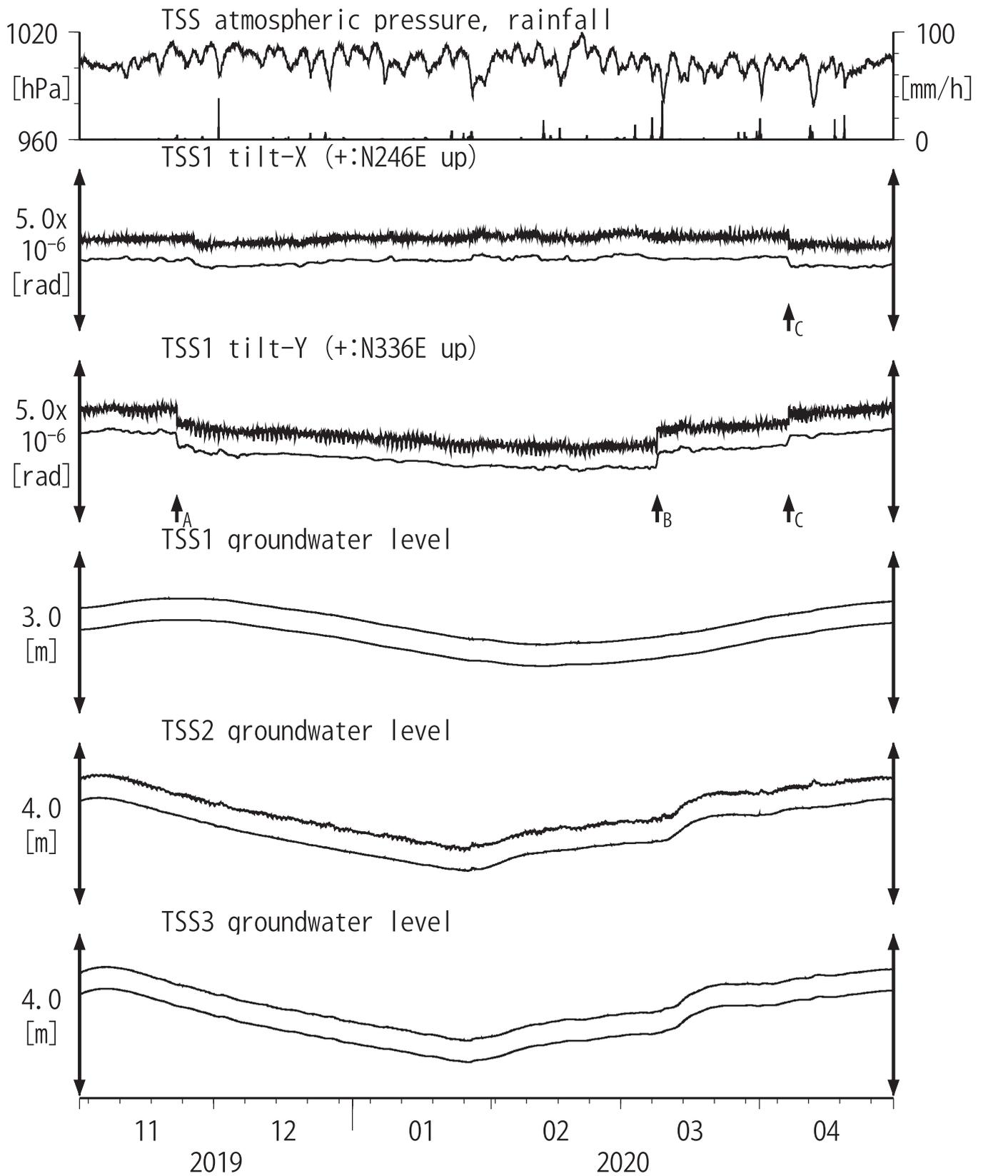
Tiltmeter depth = 586.2-587.0 [GL-m]      A:2019/11/22 日向灘の地震 M5.2
