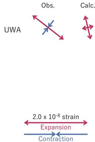
第41図 2020/02/08-11AMの変化 (第38-40図[A]) を説明する断層モデル。
