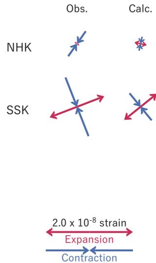
第43図 2020/02/15-18の変化 (第38-40図[C]) を説明する断層モデル。
