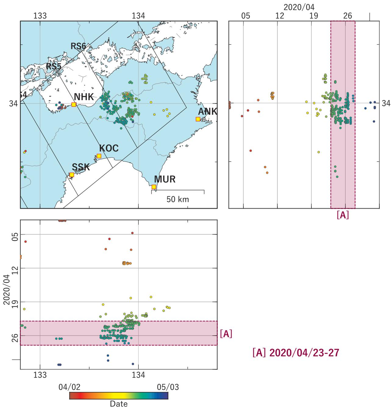
第57図 四国地方における深部低周波地震の時空間分布図 (2020/04/02 00:00:00-2020/05/03 00:00:00 (JST))。気象庁カタログによる。
