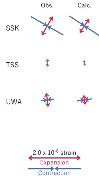
第45図 2020/02/20PM-21AMの変化 (第38-40図[E]) を説明する断層モデル。
