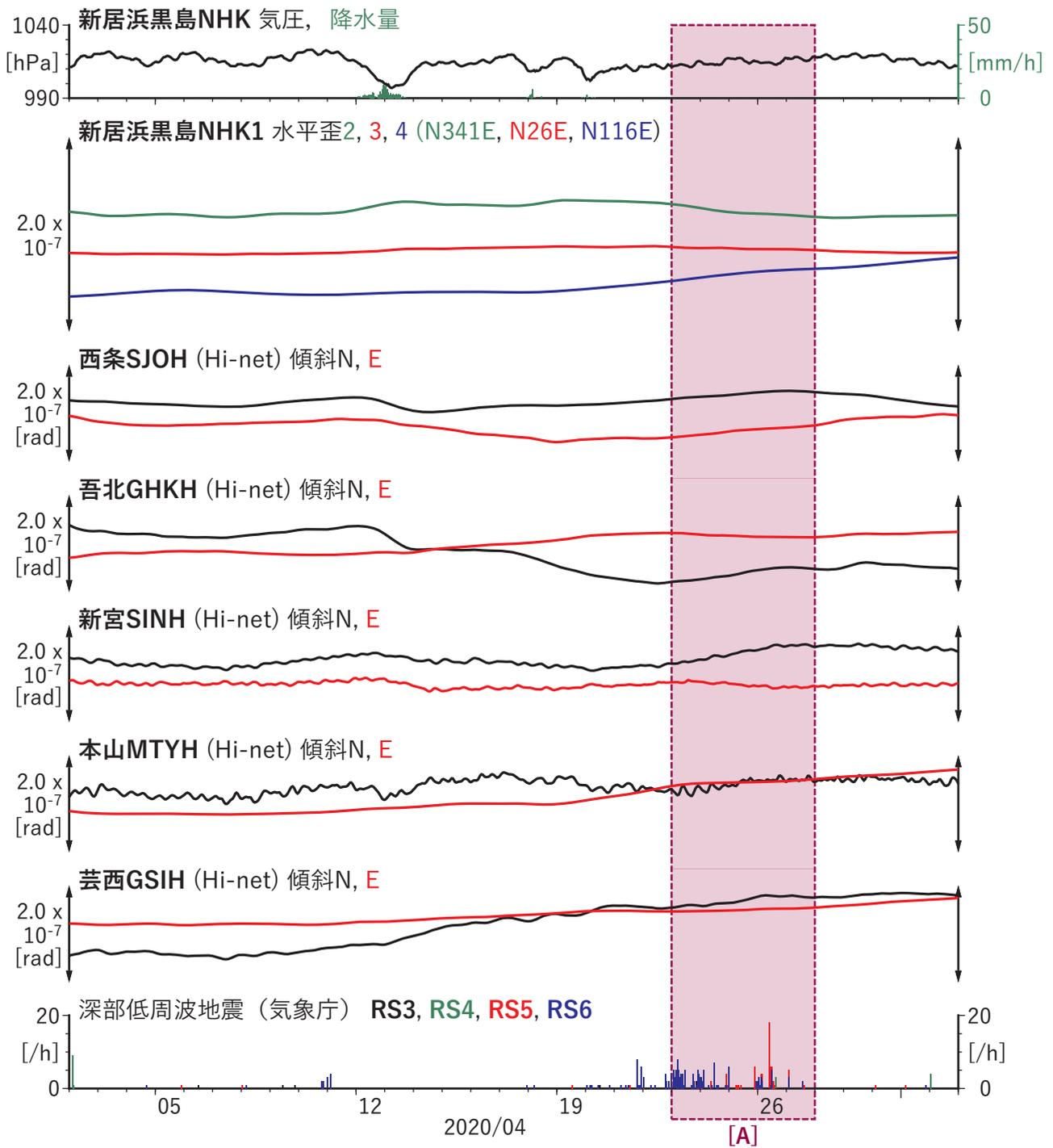
第58図 歪・傾斜の時間変化 (2020/04/02 00:00-2020/05/03 00:00 (JST))
