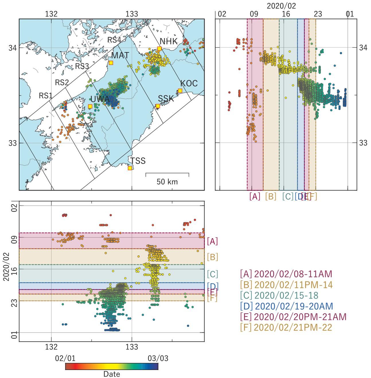
第37図 四国地方における深部低周波地震の時空間分布図 (2020/02/01 00:00:00-2020/03/02 00:00:00 (JST))。気象庁カタログによる。
