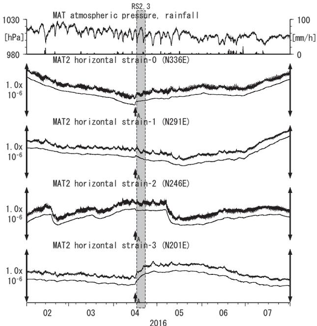
Strainmeter depth = 200.8-203.1 [GL-m] A: 2016/04/16 平成28年(2016年)熊本地震 M7.3
