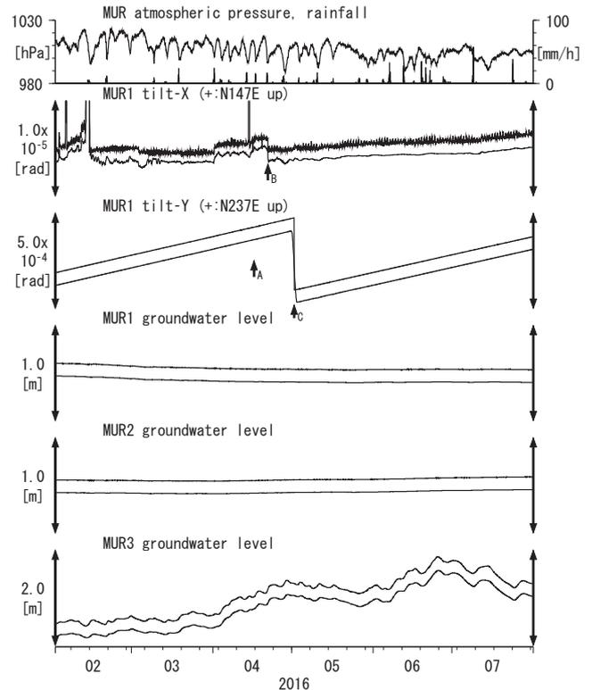
Tiltmeter depth = 586.7-587.5 [GL-m] A: 2016/04/16 熊本県熊本地方の地震 M5.4
