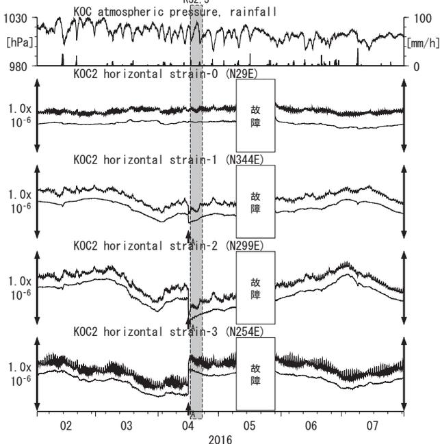
Strainmeter depth = 201.3-203.6 [GL-m] A: 2016/04/16 平成28年(2016年)熊本地震 M7.3
