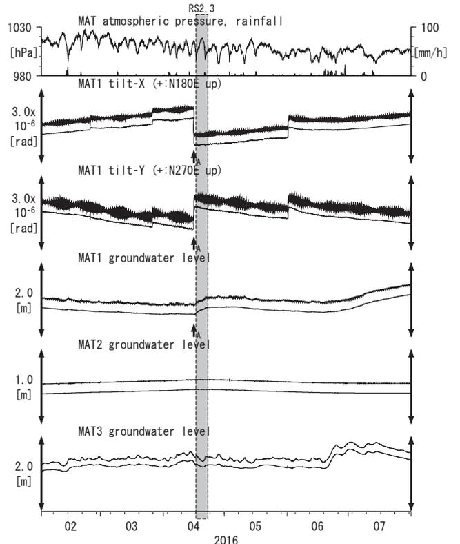
Tiltmeter depth = 596.7-597.3 [GL-m] A: 2016/04/16 平成28年(2016年)熊本地震 M7.3
