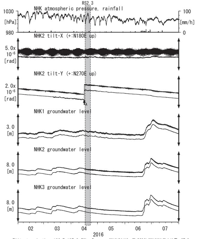
Tiltmeter depth = 196.7-197.3 [GL-m] 2016/04/16 平成28年(2016年)熊本地震 M7.3
