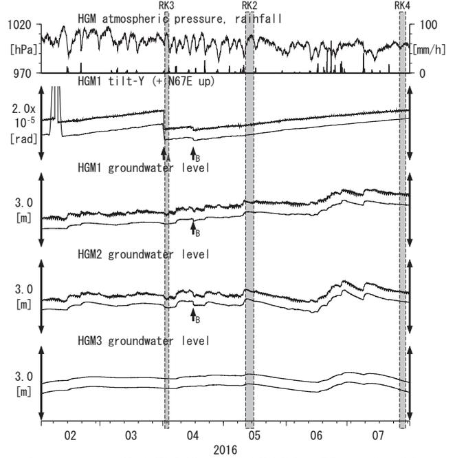
Tiltmeter depth = 371.9-372.7 [GL-m] A: 2016/04/01 三重県南東沖の地震 M6.5
