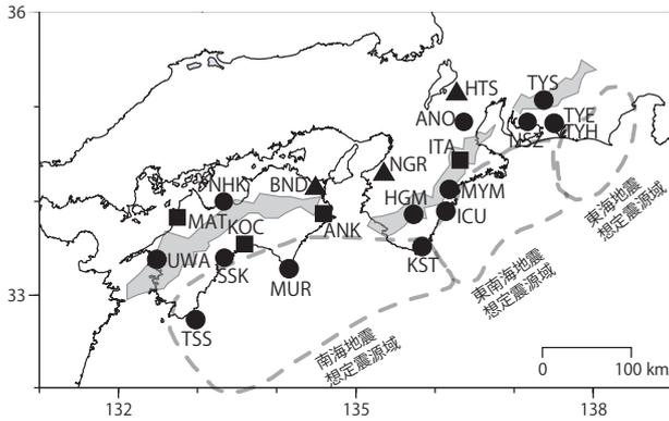
第1図: 地下水位観測点の分布図 (●・■・▲)。●はデジタル方式の石井式歪計・傾斜計を併設している新規観測点、■はGladwin式歪計・ミットヨシ傾斜計を併設している新規観測点、▲はアナログ方式の石井式歪計を併設している既存の観測点。灰色の領域は短期的SSE及び深部低周波微動が定常的に発生していると考えられる地域。
