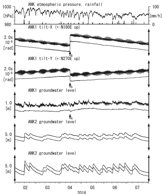
Tiltmeter depth = 616.7-617.3 [GL-m] A: 2016/04/16 平成28年(2016年)熊本地震 M7.3
