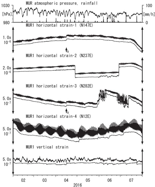
Strainmeter depth = 587.5-588.9 [GL-m] A: 2016/04/16 平成28年(2016年)熊本地震 M7.3
