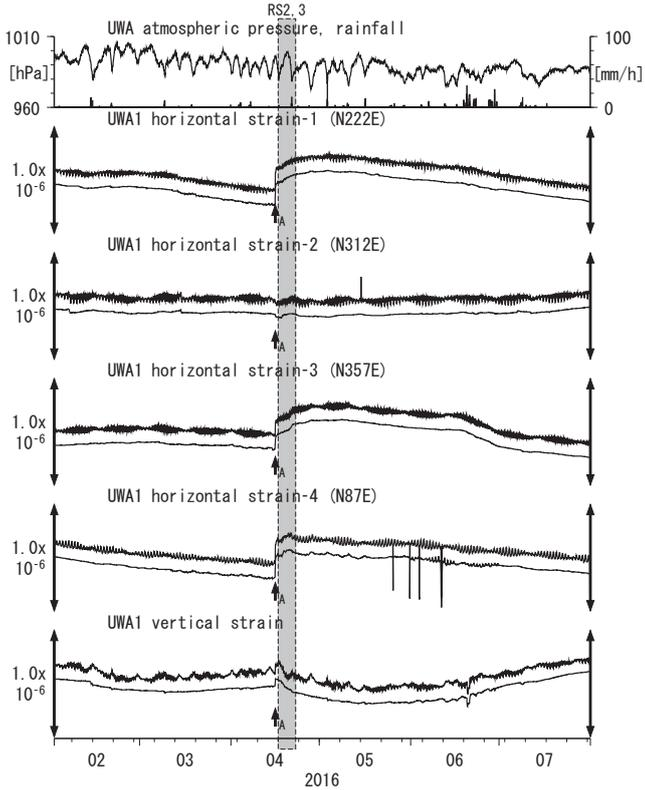
Strainmeter depth = 590.0-591.4 [GL-m] A: 2016/04/16 平成28年(2016年)熊本地震 M7.3
