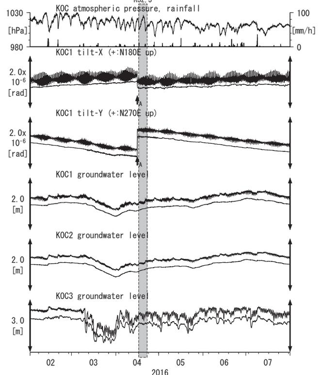
Tiltmeter depth = 597.1-597.7 [GL-m] A: 2016/04/16 平成28年(2016年)熊本地震 M7.3
