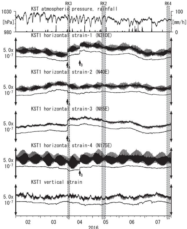
Strainmeter depth = 589.8-591.2 [GL-m] A: 2016/04/01 三重県南東沖の地震 M6.5
