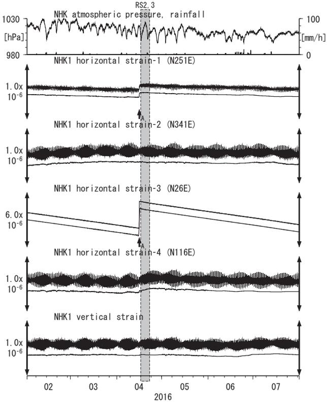
Strainmeter depth = 481.0-483.0 [GL-m] A:2016/04/16 平成28年(2016年)熊本地震 M7.3
