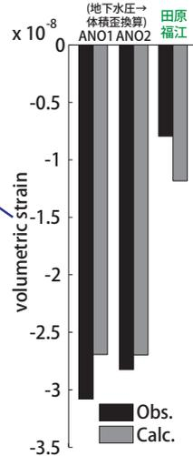
第51図: 2016/07/26-30の歪・傾斜・地下水変化(第50図[A])を説明する断層モデル。
