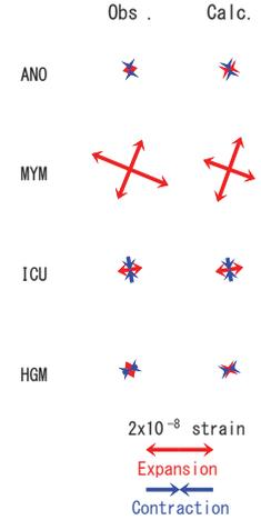
第48図: 2016/5/13-14 の歪・傾斜変化 (第46図[B]) を説明する断層モデル。
