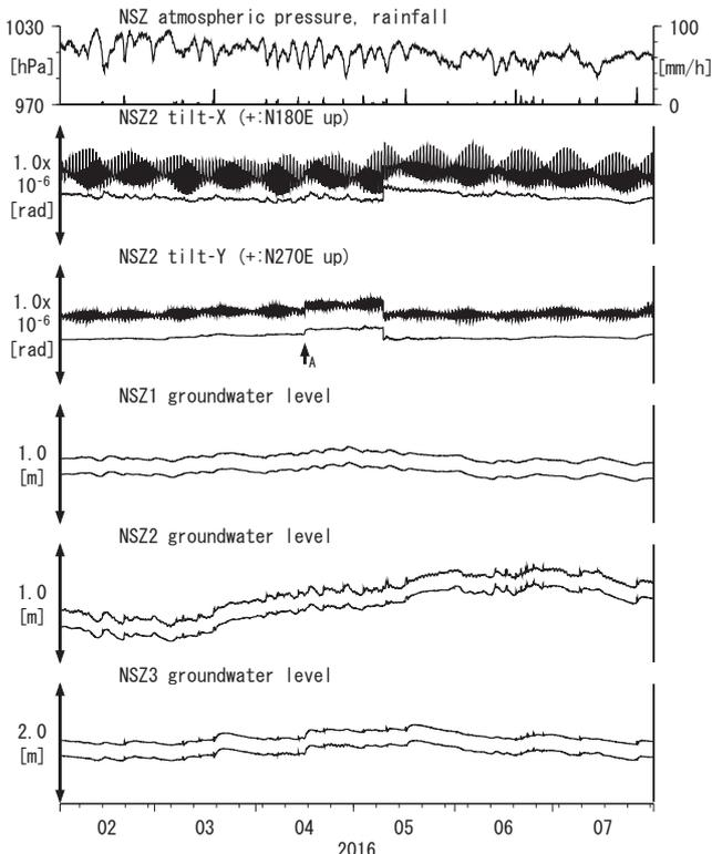
Tiltmeter depth = 194.7-195.3 [GL-m] A: 2016/04/16 平成28年(2016年)熊本地震 M7.3
