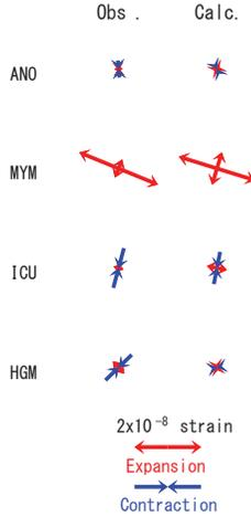
第47図: 2016/5/12-13 の歪・傾斜変化 (第46図[A]) を説明する断層モデル。
