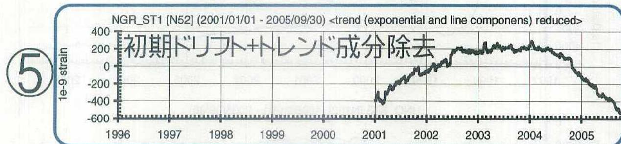
図2. 歪記録処理の例。初期ドリフトを②指数関数によって近似する。トレンド成分を④直線近似する。③は長期的な地殻歪蓄積の傾向を表す。⑤は短・中期的な地殻歪レートの変化を検出する際に用いる。
