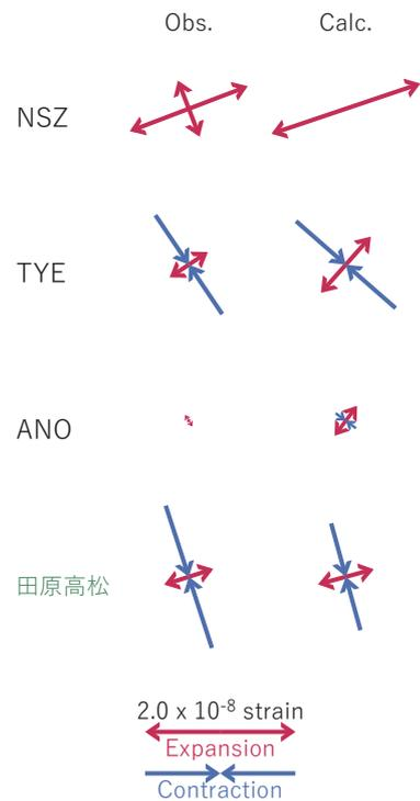
図13 2025/07/12PM-15AMの歪・傾斜変化 (図10[C]) を説明する断層モデル。
