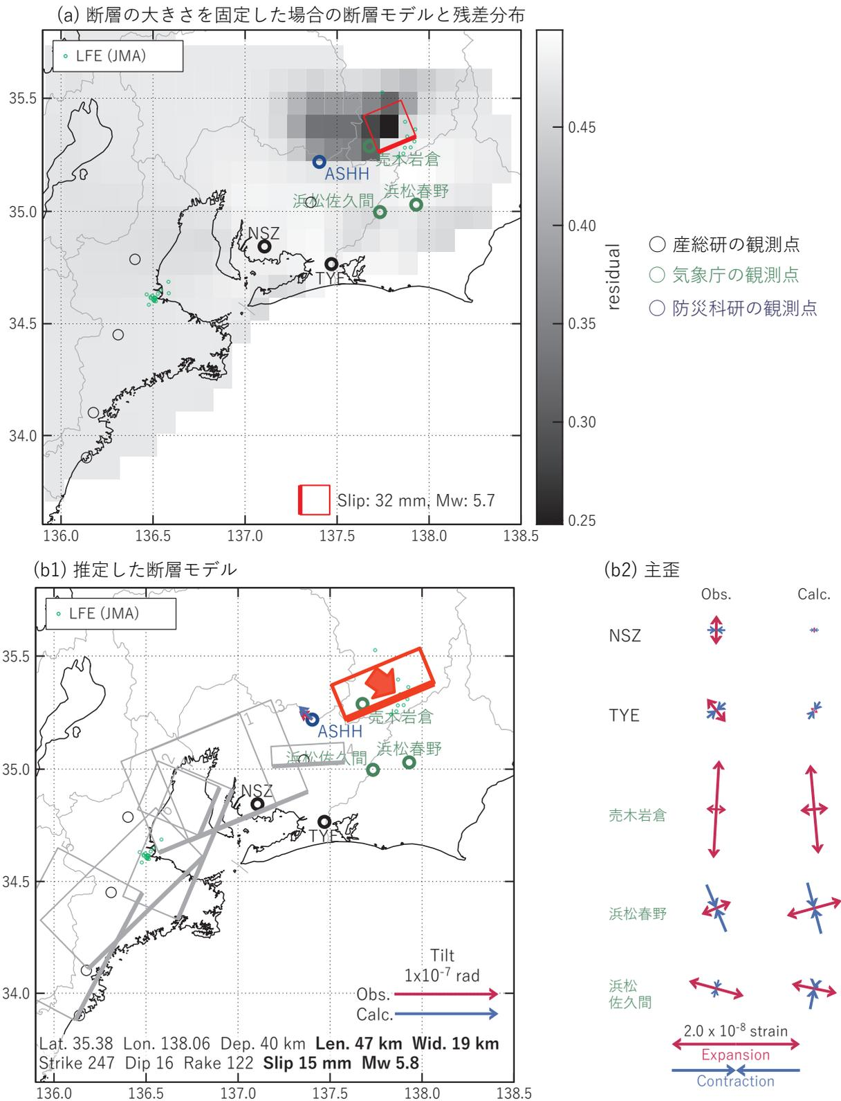
図11 2025/07/04PM-06の歪・傾斜変化 (図10[A]) を説明する断層モデル。
