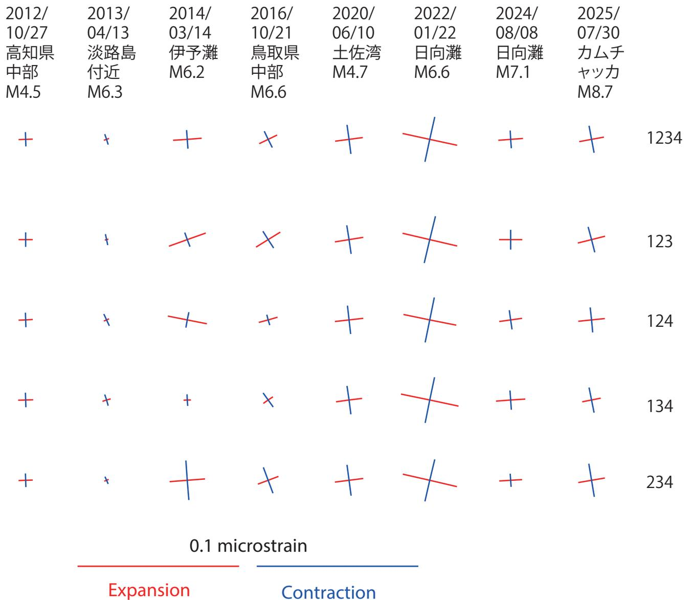
図4 地震後の須崎大谷のひずみ変化の主歪場(8例)
