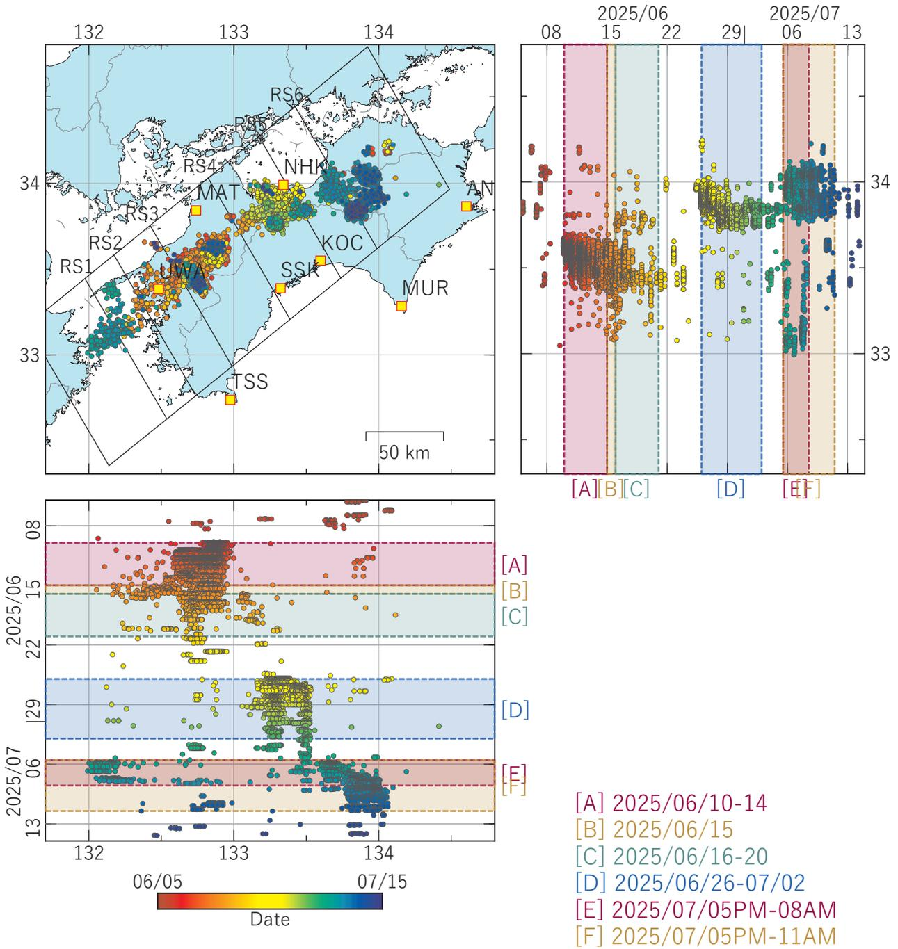
図1 四国地方における低周波地震の時空間分布図（2025/06/05 00:00 - 2025/07/15 00:00 (JST)）。気象庁カタログによる。
