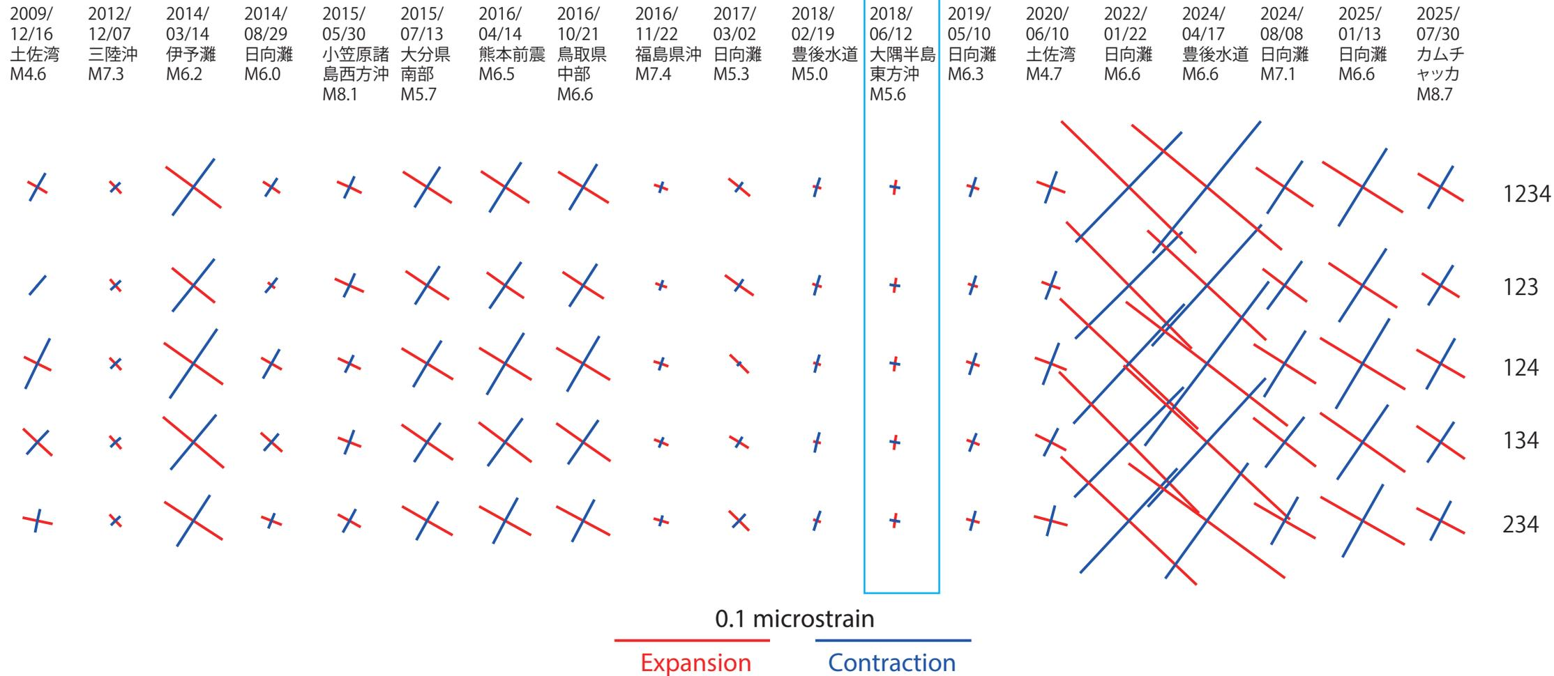
図2 地震後1日間の土佐清水松尾のひずみ変化の主歪場(19例)
