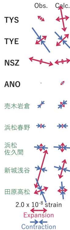
図3 2023/12/23-24の歪・傾斜変化(図2[A])を説明する断層モデル。
