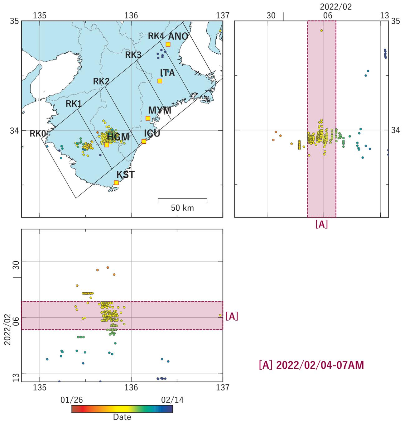
図1 紀伊半島における深部低周波地震の時空間分布図 (2022/01/26 00:00:00-2022/02/14 00:00:00 (JST))。気象庁カタログによる。
