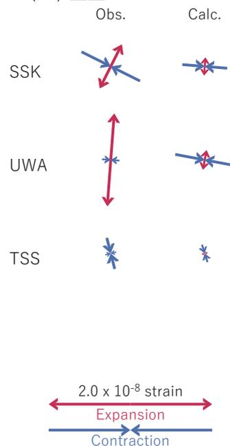
図7 2021/07/28の歪・傾斜変化 (図2,3[D]) を説明する断層モデル。
