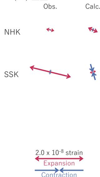
図4 2021/07/18-19AMの歪・傾斜変化 (図2,3[A]) を説明する断層モデル。
