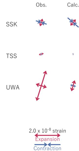
図10 2020/02/21PM-22の歪・傾斜変化 (図2-4[F]) を説明する断層モデル。
