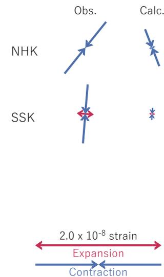
図6 2020/02/11PM-14の歪・傾斜変化（図2-4[B]）を説明する断層モデル。
