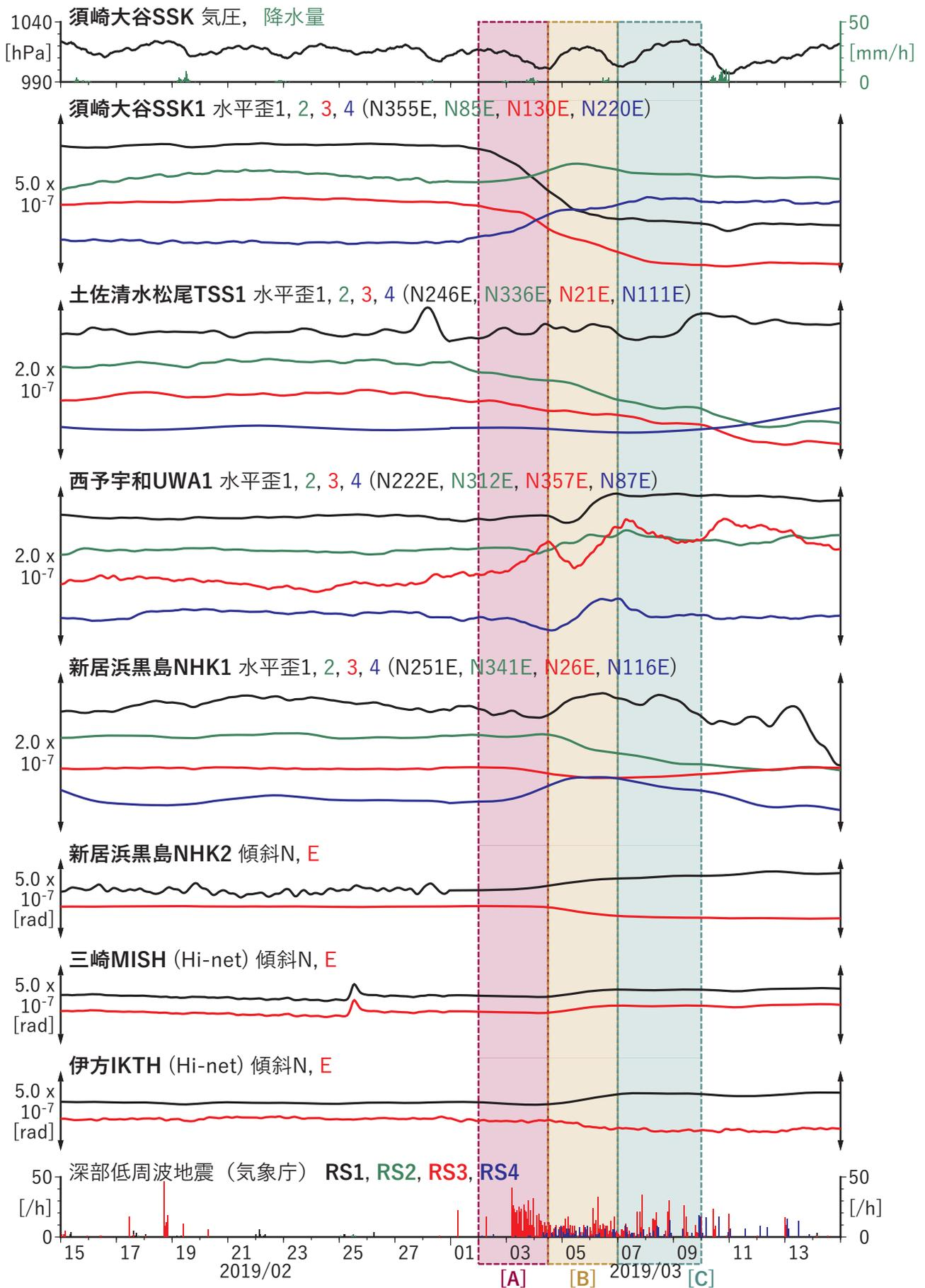
図6 歪・傾斜の時間変化 (2019/02/15 00:00 - 2019/03/15 00:00 (JST))
