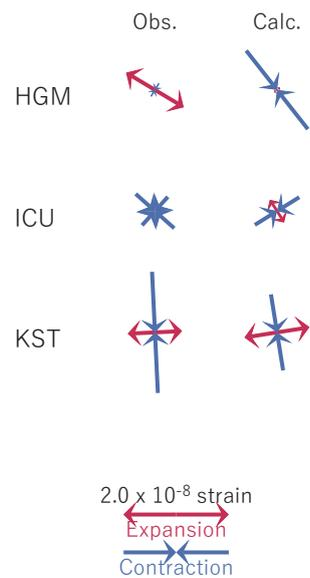
参考図3 2018/11/03-06の歪変化（参考図2[A]）を説明する断層モデル。
