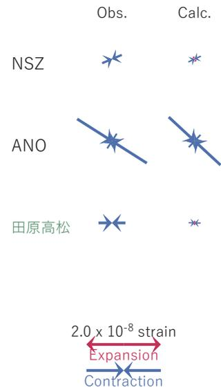
図5 2018/09/26-28AM の歪・傾斜変化 (図2[C]) を説明する断層モデル。
