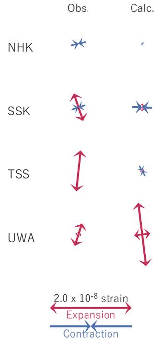
図11 2018/10/02-03 の歪・傾斜・地下水変化 (図9[B]) を説明する断層モデル。
