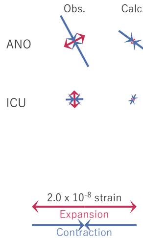
図4 2018/09/22PM-25 の歪・傾斜・地下水変化 (図2[B]) を説明する断層モデル。
