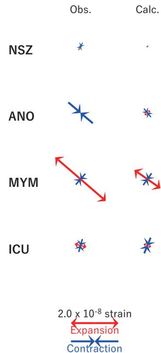
図4 2017/11/18-19の歪・傾斜変化 (図2[B]) を説明する断層モデル。
