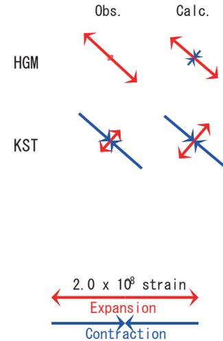
図26 2017/07/25-28の歪変化(図25[A])を説明する断層モデル。
