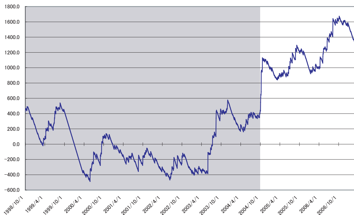
榛原観測井 降雨量の積算からトレンド除去後のグラフ (mm) (1998. 10. 1-2007. 3. 20)
