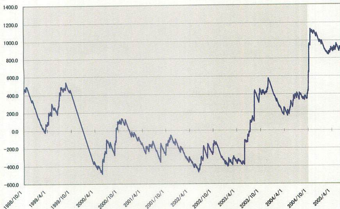
榛原観測井 降雨量の積算からトレンド除去後のグラフ (mm) (1998. 10. 1-2005. 6. 21)
