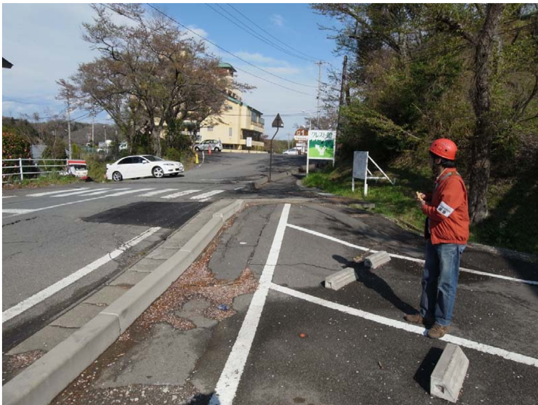
写真 12 : 常磐藤原町源内の南西 ( 36^{\circ} 59.71' N , 140^{\circ} 48.91' E ) 写真手前に主断層に沿った撓曲変形. 写真奥の坂道に派生する副断層 2 (赤色と黄色のコーンの間).
