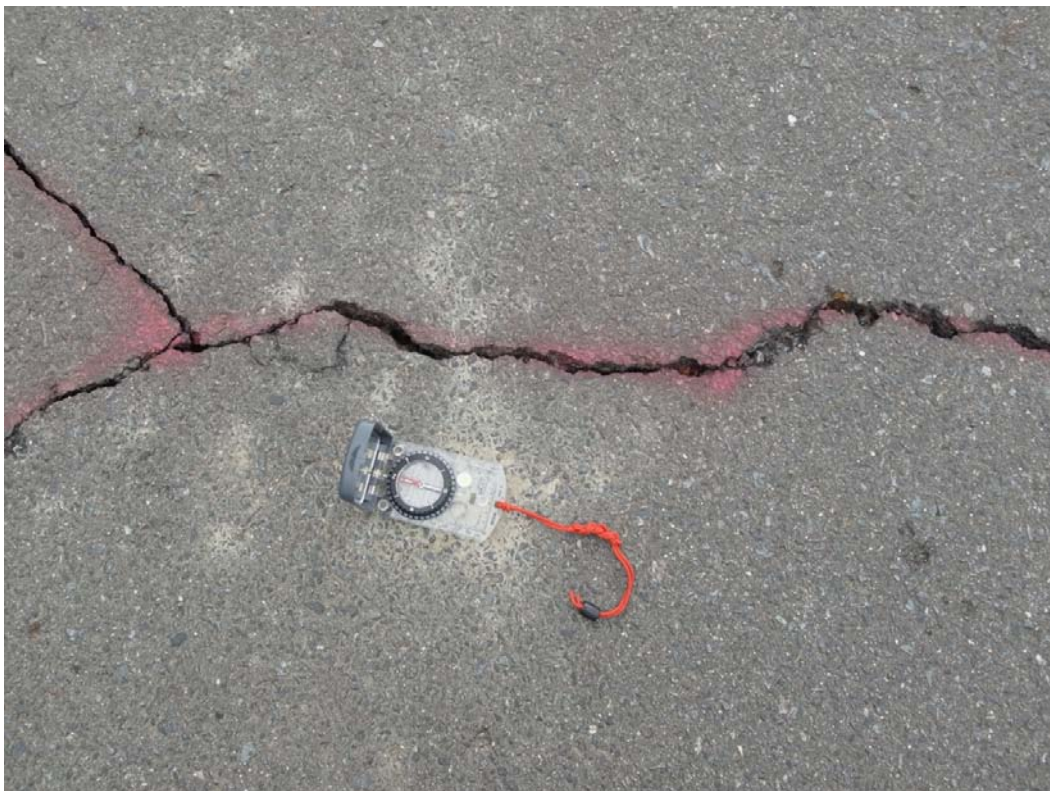
写真 18 : 遠野町入遠野越台の南南東 0.4km ( 37^{\circ} 3.22' N , 140^{\circ} 41.60' E ) 写真 17 地点の一部拡大。ジグソークラックの圧縮・伸張パターンから右横ずれが読み取れる。
