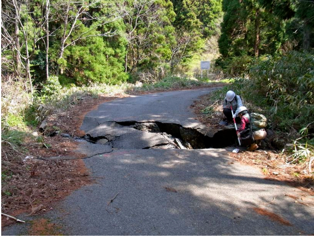
写真 9 : 常磐藤原町小幡の北西 0.7km ( 37^{\circ} 0.98' N , 140^{\circ} 47.21' E ) 断層の走向 280^{\circ} に 対して変位ベクトルの方位角は 182^{\circ} . このため、右横ずれ成分を伴う
