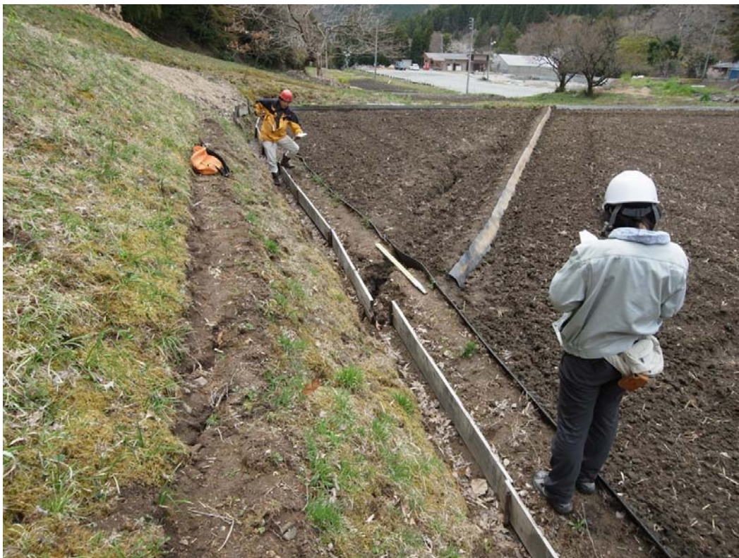
写真2：遠野町入遠野官沢の付近 (37° 3.74' N, 140° 41.69' E) 南西下がり15cmの断層変位のために水田が2分された. 畦道のずれは、左ずれ15cmと水平伸張20cm
