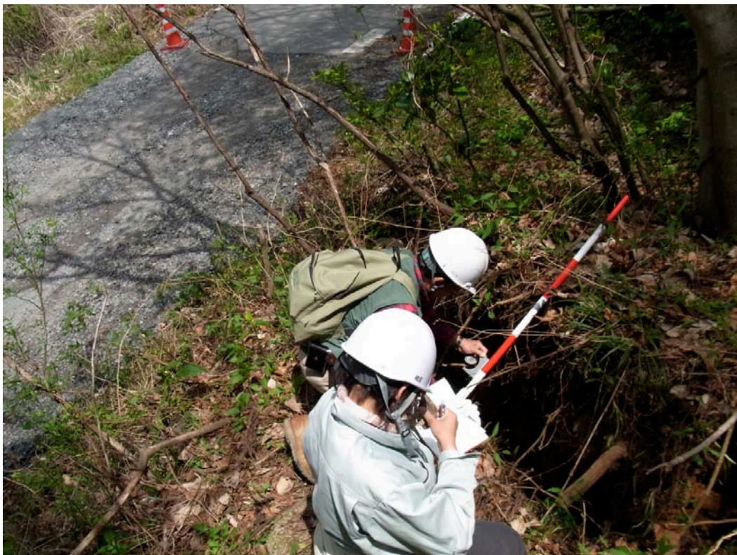
写真 8 : 常磐藤原町小幡の西北西 1.4km ( 37^{\circ} 1.28' N , 140^{\circ} 46.86' E ) 雑木林のジグソークラックを基準に, ネット変位量 62cm・方位角 228^{\circ} ・伏角 40^{\circ} の変位ベクトルを計測.
