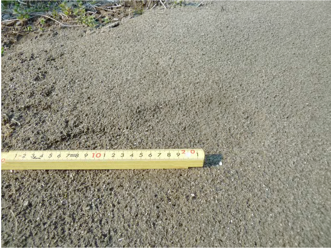
噴砂した砂。細粒で貝殻片を多量に含む。河口付近もしくは海の浚渫砂と思われる。
