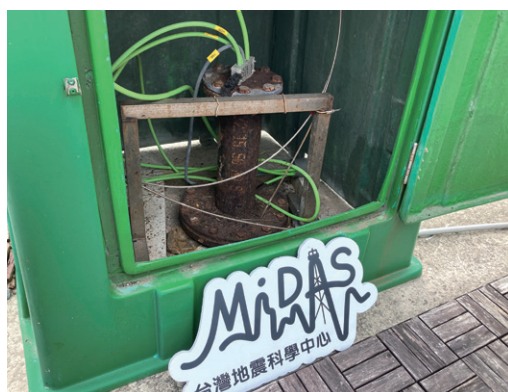
写真5 MiDASの立坑（Hole B）のwellhead。鉄線のようなものの中に光ファイバーがあり、地下500mまで伸びています。緑色と灰色のケーブルは立坑内の複数の地震計に接続されています。
