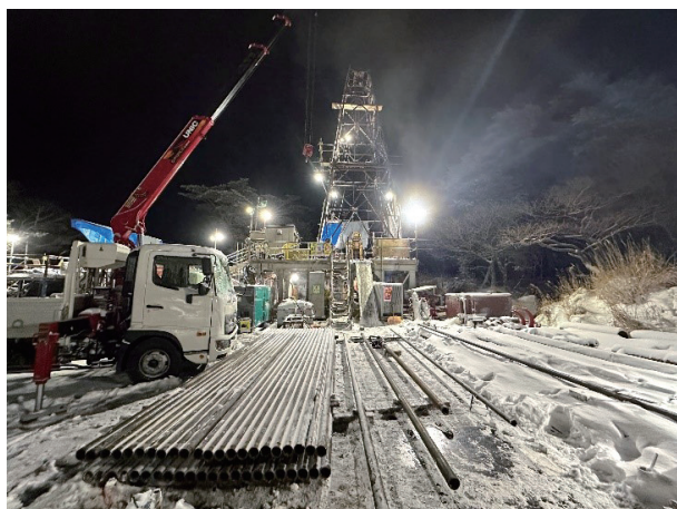
図2 ボーリング掘削の最終段階(2025年3月18日午後9時34分頃)。275 m分の掘削管が並べられて検尺を行うところ。霧島火山群硫黄山標高1200 m付近(古川撮影)。
