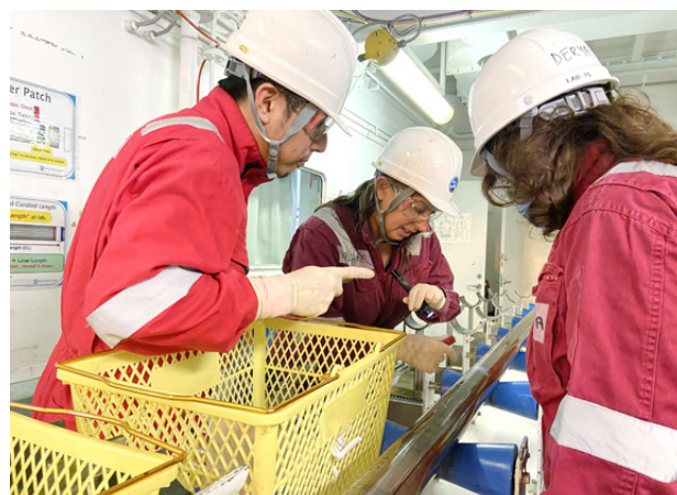
図3 コアを切断する箇所を相談している様子。掘削直後のコアを懐中電灯で観察し、重要な構造を避けながら手動でコアを切断する。
