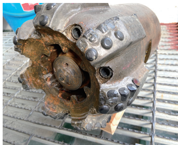
図1 掘削に使用したコアビット。チャート層の掘削によりダイヤモンドでできた歯が欠損している。
