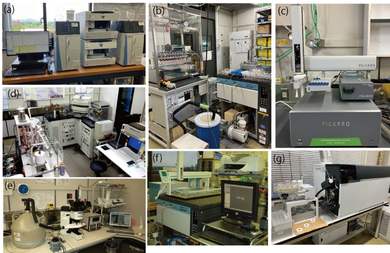
写真3 深部流体の化学分析に用いられる分析装置。(a) イオンクロマトグラフ (Thermo Fisher Scientific 社製 イオンクロマトグラフ ICS- 2100), (b) 酸素同位体質量分析計 (Thermo Fisher Scientific 社製 Delta V Advantage and Delta Plus), (c) 水同位体比アナライザー (Picarro 社製 L2130-i), (d) 希ガス質量分析計 (Micromass 社製 MM5400), (e) 流体包有物加熱・冷却実験装置, (f) 炭素同位体質量分析計 (Thermo Fisher Scientific 社製 Delta plus), (g) ICP 質量分析計 (アジレント・テクノロジー社製 Agilent 8900).
