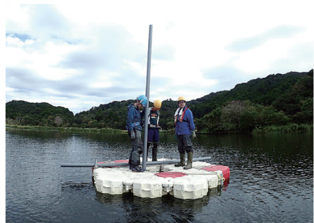
写真3 湖底の堆積物を採取するため、水上からコアリングすることもあります (GSJ 研究資料集 no. 741)。
