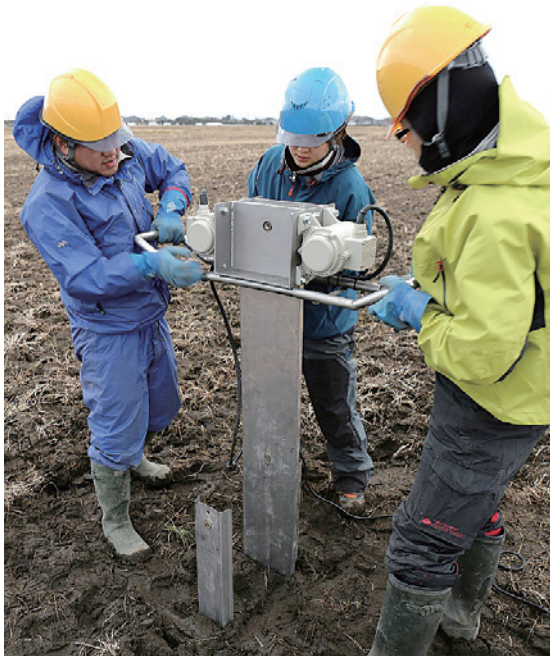
写真1 ハンディジスライサーと呼ばれる道具を使用して地層を抜き取って観察します。写真は千葉県九十九里浜周辺での調査風景です (GSJ 研究資料集 no. 741)
