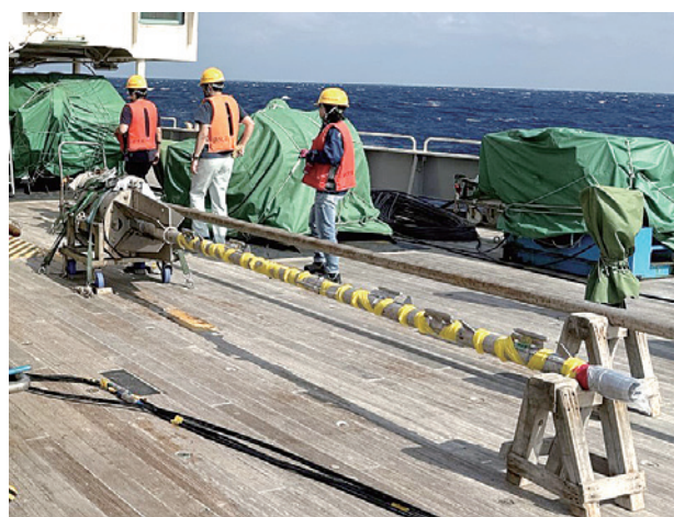
写真3 ピストンコアラ。この写真ではコアラーに温度計をつけた状態で、採泥と地殻熱流量測定を一緒に行うことができます。
