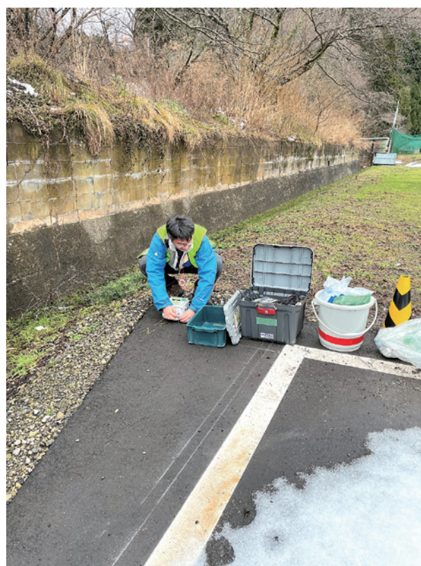
写真4 地震計の設置風景．蓄積されたデータは，詳細な余震活動や地盤特性の把握のために活用される．
