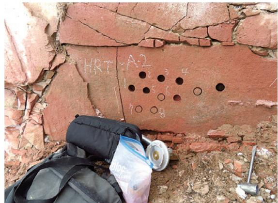
写真3 ハンドドリルで試料採取した露頭の様子。
