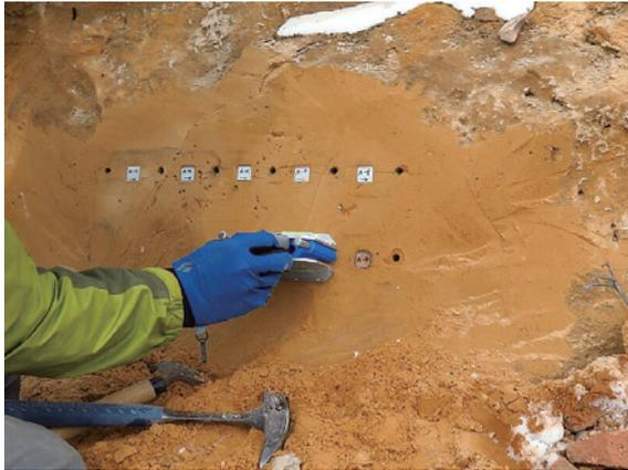
写真4 キューブと治具で試料を採取する様子。治具で固定しながらキューブを堆積物に差し込んで試料を採取します（写真ではいくつかのキューブがすでに堆積物に差し込まれています）。
