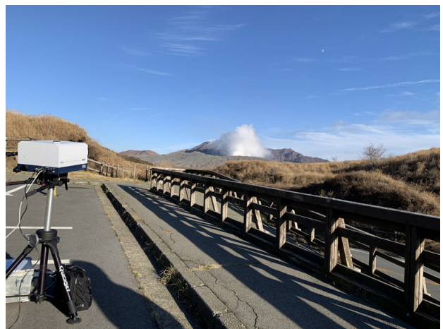
図4 可搬型 FT-IR 観測装置を用いて阿蘇中岳の火山ガス組成を遠隔観測している様子。
