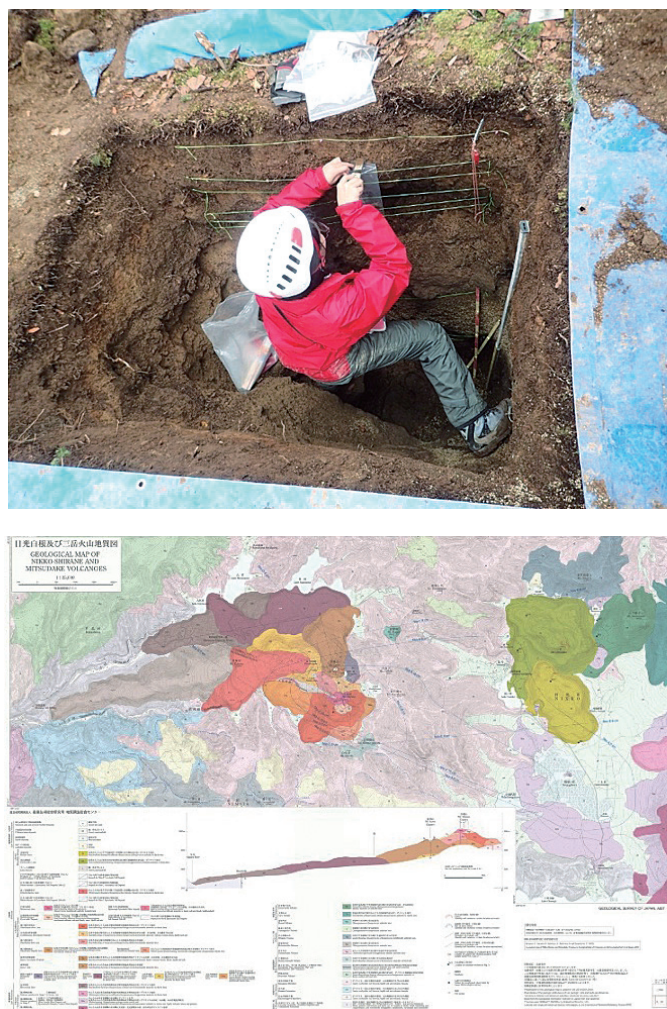
図1 日光白根及び三岳火山地質図。(上) トレンチにすっぽり入って火山灰層を調べています。(下) 2022年9月に刊行された火山地質図。断面図など地質学的に高度な技術が多色刷り地形陰影付きで表現されています。
