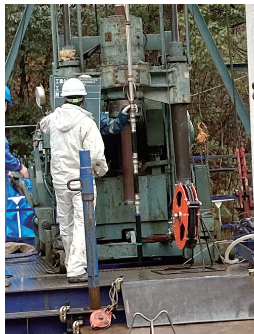
写真2 孔1のセメントボンド検層の実施状況。
