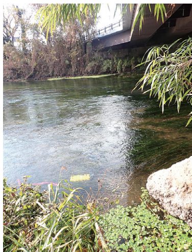
図5 上江津湖と下江津湖をつなぐ加勢川に沈めた水中地震計（黄色の物体：この区間に4個設置）。
