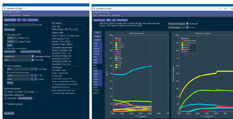
写真 17 easyMELTS の入力画面 (左) と計算結果例 (右)。入力画面では計算に必要な情報が分かりやすく示されている。計算結果はプログラム上で簡単に確認でき、詳細な結果は Excel ファイルへ出力することができる。
