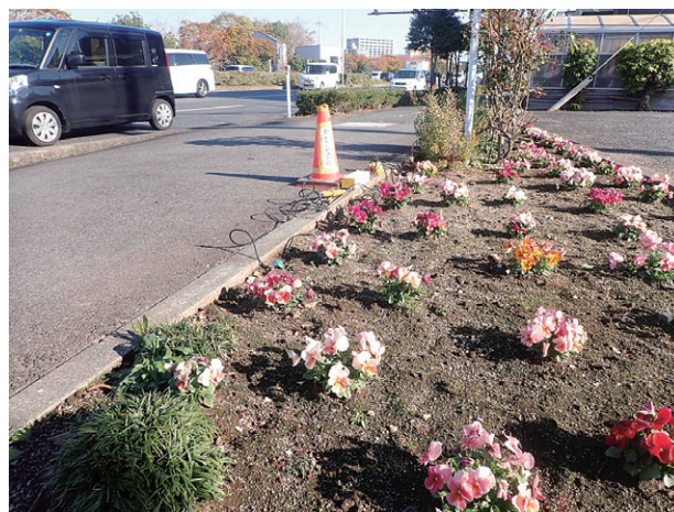
図4 道路沿いの地震計設置の様子（花壇に複数の地震計（青）を埋め、黄色の機器にデータを集約）。
