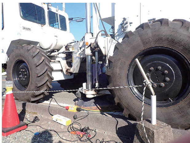
図6 発振中の様子（中央の黒いプレートを地面に押し付け、震動を地面に伝えている）。
