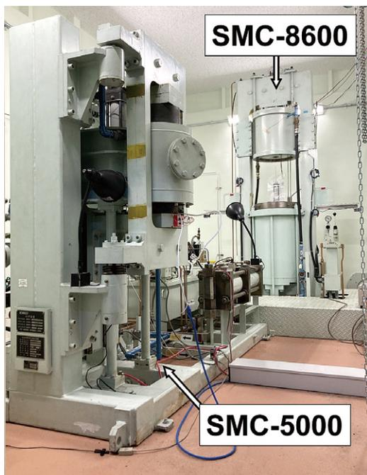
図1 産総研に設置された内熱式ガス圧装置。左手前が本研究で使用した SMC-5000（最高圧力 481 MPa）で、右奥が SMC-8600（最高圧力 850 MPa）。
