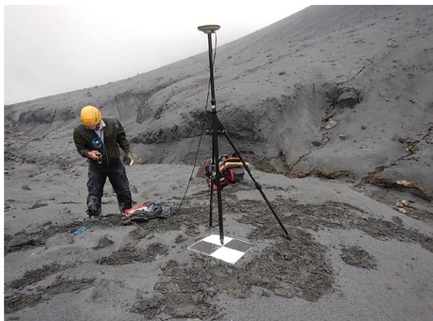
写真1 対空標識の設置作業のようす。地面に固定された白黒のパネルが対空標識で，GPSによる位置座標の計測を実施しているところを撮影しました。
