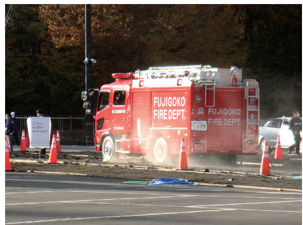
写真2 火山灰上を走行する消防車。細粒火山灰が車両に巻き上げられているのが視認される。また、火山灰層厚が、途中から増すことを示す看板が立てられている。
