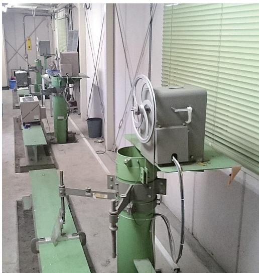
写真 1 <sup>かんそくせい</sup> 観測井の例。地面から垂直に立つ管が観測井であり、この施設内には深度の異なる観測井が3本設置されている。観測井には地盤沈下および地下水位のモニタリング機器が取り付けられている。
