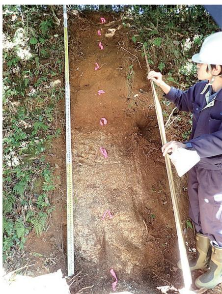
写真3 露頭からの試料採取後の様子。ピンクのテープが試料を採取した箇所。
