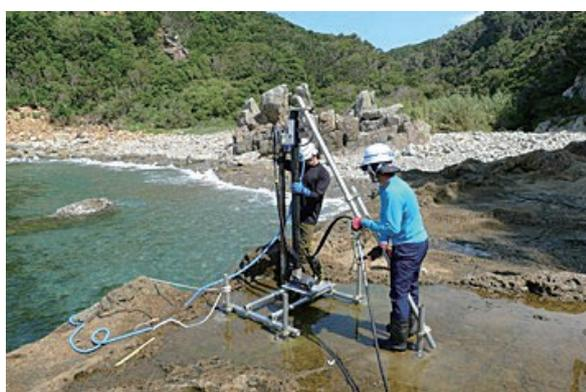
写真2 紀伊大島でのボーリング掘削の様子。
