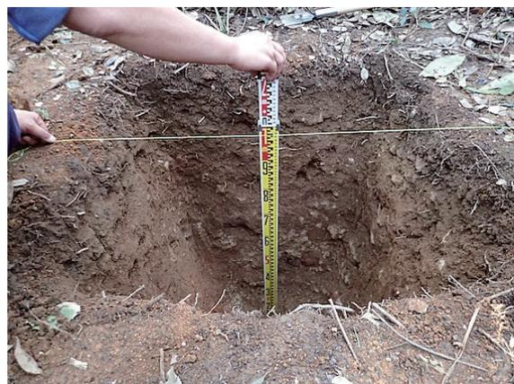
写真5 ピット掘削による試料採取。
