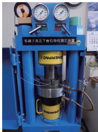
図 2 東北大学の大学院での研究に用いたピストンシリンダー型高温高压発生装置。下部地殻～上部マントルに相当する高温高压条件を再現することができる。高压を発生するために試料の大きさは mm サイズに限られる。
