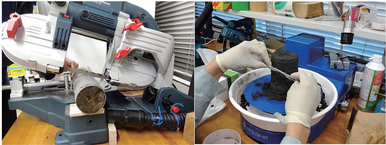
図4 ポーリングコアの切断（左）と間隙水抽出のためのコア試料の前処理（右）.
