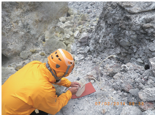
写真 6 火山ガス凝縮水の採取風景．右側端の噴気孔に差し込んだチタン製パイプからゴム管を経由して，手元まで火山ガスを引き込み，ガラス容器に採取します．プラスチック容器の中には氷水が入っていて，ガラス容器に引き込まれた火山ガスを冷却して試料を採取しています．
