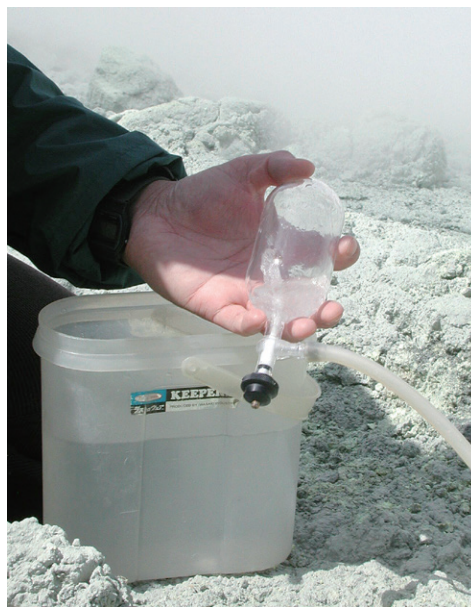
写真 7 火山ガス採取に用いられる Giggenbach Bottle.
