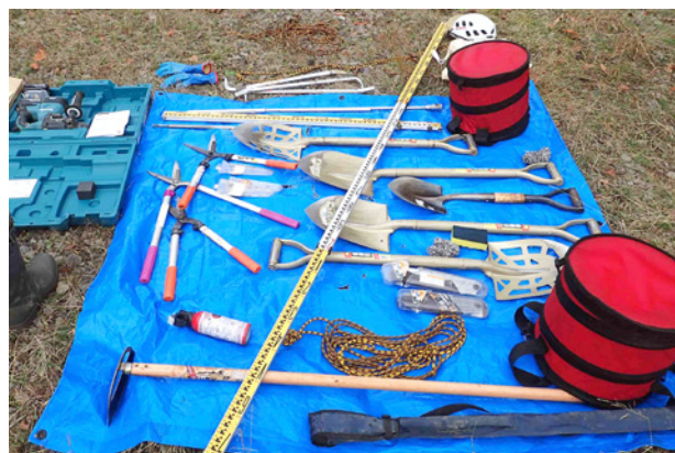
写真4 担いで持ち上げた掘削装備一式。左から電動ドリル、剪定ばさみ、スケール、バール、スコップ大中小、立鎌、検土杖、ロープ、鋸、バケツ、ブルーシートなど、調査終了後に川で洗って干しました。
