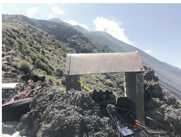
図2. ストロンボリ火山での SO 2 放出量観測の様子。画面中央にあるのはマンチェスター大学の観測装置で SO 2 カメラ(黄色矢印)と紫外分光計(赤矢印)。両者とも火山口の噴煙(画面上側)に向けられている。日射による機材温度上昇を防ぐために日除けを用いている。
