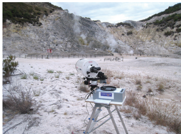
図2 赤外線分光を用いた火山地域でのCO 2 放出率測定の様子。写っている装置はLARRSベースのCarbSensというマンチェスター大学開発の観測用キット ( http://www.carbsens.com/ )。
