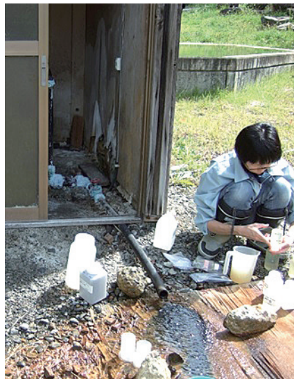
写真1 現場で温泉水を採取している様子。現場では、温度、pH、電気伝導度などを測定します。分析ごとに保管する容器の材質や容量が異なるため、採水の方法は様々です。地下水をくみ上げている深度は、どの地層から水を取っているのかを知るために重要な情報となりますので、井戸の掘削資料を見せていただくこともあります。
