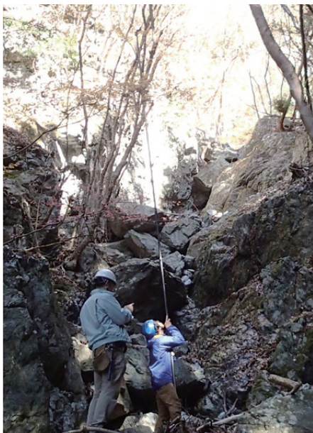
写真 3 高所撮影用ポールと遠隔操作可能なデジタルカメラによる画像撮影。
