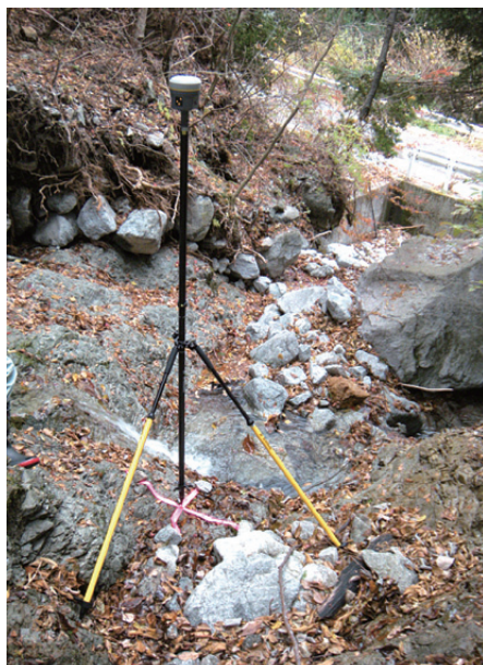
写真 1 地上基準点 (GCP) の位置を決定するために用いた GNSS 測量機材。
