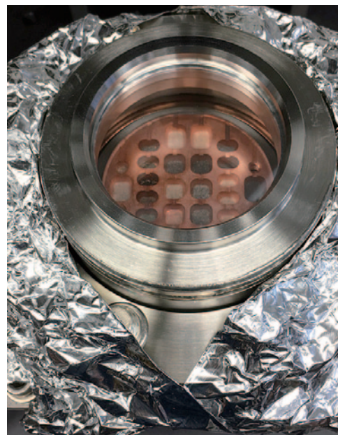
写真4 照射を終えた試料は開封して銅のトレイに乗せ、真空ラインに装着します。このガラス窓の上からレーザーで加熱して試料中ガスを取り出します。
