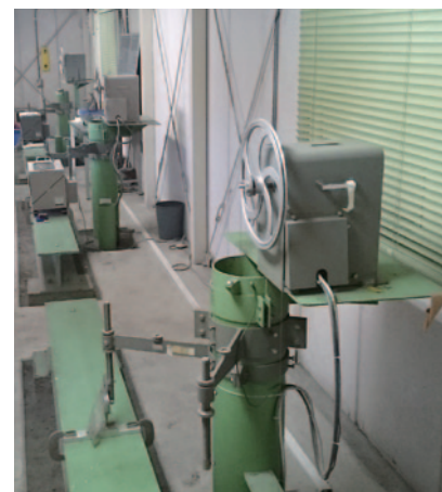
写真1 観測井（かんそくせい）の例。地面から垂直に立つ管が観測井であり、この施設内には深度の異なる観測井が3本設置されている。観測井には、地盤沈下や地下水位のモニタリング装置が取り付けられている。
