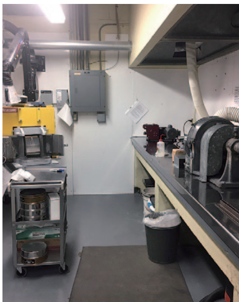
写真2 地下にある岩石切断、粉碎室。卓上のミニジョークラッシャーはなかなか便利です。
