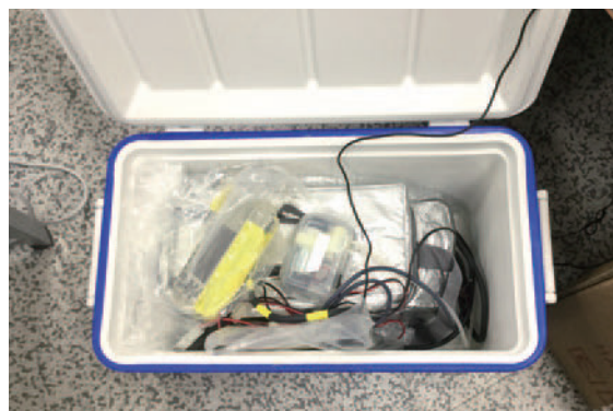
写真2 観測装置の防寒対策。ガスセンサー群を断熱バッグ（銀色）に入れ、ヒーターとホッカイロをバッグ内部に入れる事で、センサーの温度を保っています。断熱バッグとロガー（記録装置）、ガス吸引ポンプをクーラーボックスに入れ、密閉する事で断熱しています。
