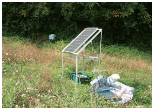
写真2 ソーラーパネルを用いた臨時観測風景。ソーラーパネルの架台の下に見えるケースにバッテリーと収録装置を格納しています。地震計は写真奥の岩盤上に設置しています。現在は収録装置の低消費電力化が進んだおかげで、ソーラーパネルによる充電を行わなくても長期間の連続観測ができるようになっています。
