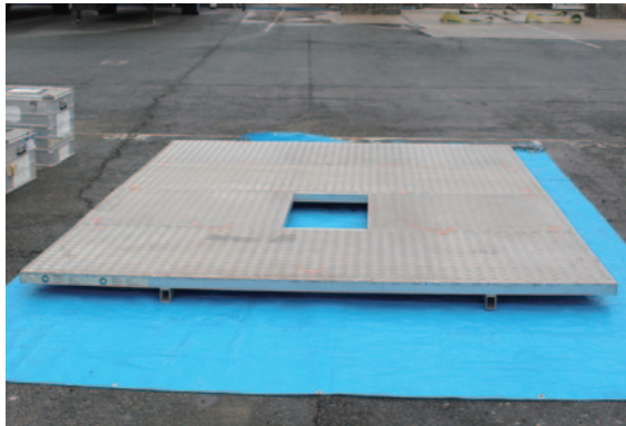
図1 組み立て中のコアリング用の筏。
