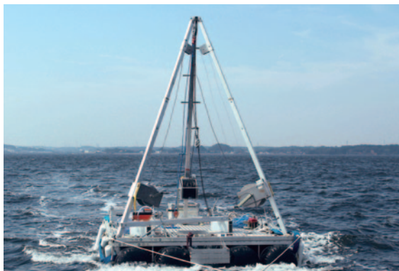
図2 曳航中の筏。3×4 mの広さの足場の上に組み立てられた檣から、コアラーを湖底に下ろすことができます。
