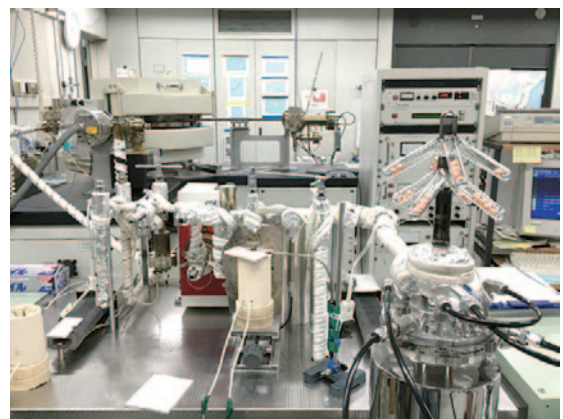
写真 3 テープヒーターで巻かれた前処理ラインと質量分析計。
